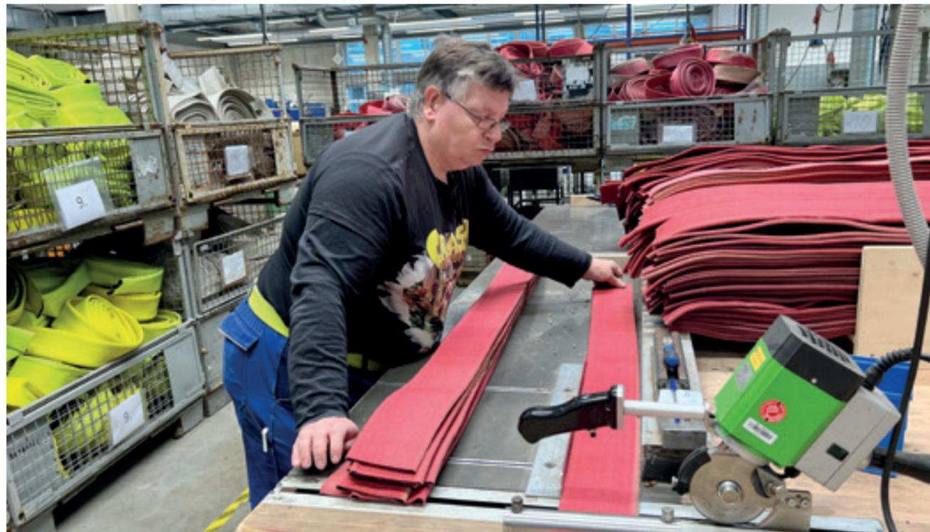
Mit einer speziellen Schneide-Anlage werden Feuerwehrschräume auf Maß für die Fertigung von Taschen gebracht
